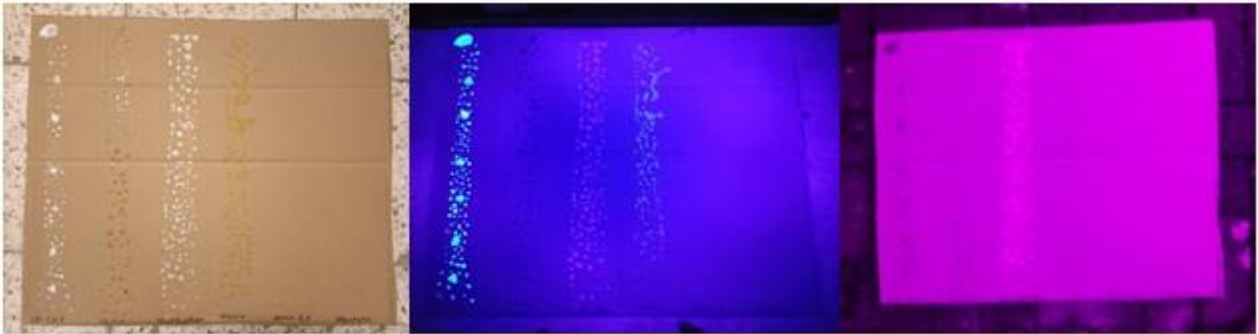
Abb. 2: Mögliche UV-Marker und Kontrolle auf Pappe, aufgenommen (1 m Abstand) im menschlich wahrnehmbaren Lichtspektrum (links), im Dunkeln mit Licht durch UV-Filter (285 nm) bestrahlt (mittig), und bei Tageslicht (bewölkt, 13.12.2023) mit Kolaris-UV-Linse und DJI Mavic2Pro aufgenommen (rechts). Es handelt sich um (von links nach rechts): UV-Lack, Tonic/Chinin, Tryptophan, Uranin, Aqua destilata und Mäuseurin, jeweils in abgetrocknetem Zustand.
